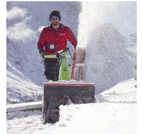
Schneefräse mit dem vollelektrischen Einachsgeräteträger Uri E041 von Rapid. (Foto: Rapid)
